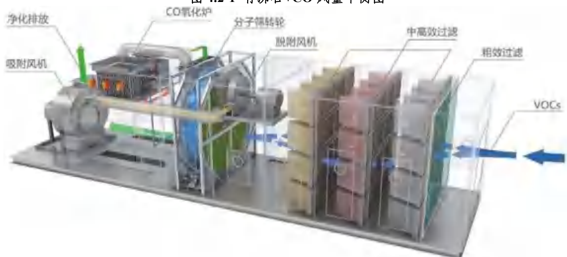
图 4.2-2 沸石转轮+CO 治理系统示意图
